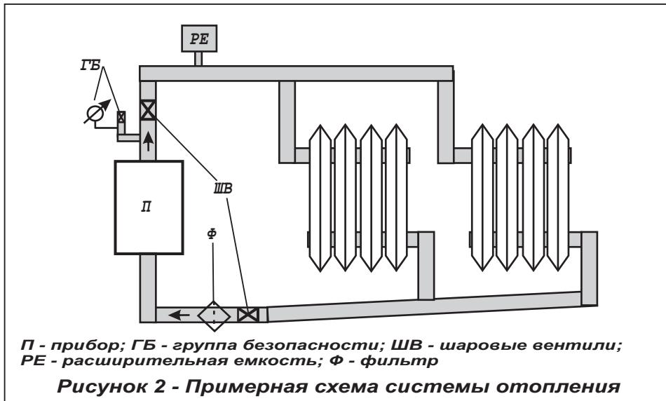
**Рисунок 2 - Примерная схема системы отопления**
