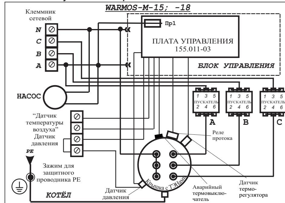
**Рисунок 5 - Электрическая схема подключения**
